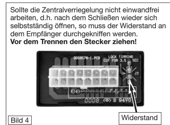
Sollte die Zentralverriegelung nicht einwandfrei arbeiten, d.h. nach dem Schließen wieder sich selbstständig öffnen, so muss der Widerstand an dem Empfänger durchgekniffen werden. **Vor dem Trennen den Stecker ziehen!**
