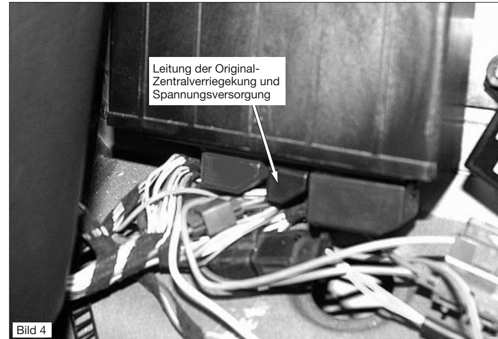
Audi Cabrio - Anschluss der Spannungsversorgung und Steuerleitung
